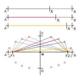
2) Der halbe große Durchmesser, M-B wird in den Zirkel genommen und von C beidseitig auf den großen Durchmesser aufgetragen. Damit werden die Brennpunkte F1 und F2 bestimmt.
