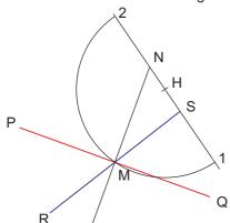
7) Nun ergibt sich auf der Gerade 1-2 die kleine Achse KA zwischen N und 2 und die große Achse GA zwischen N und 1. Diese Achsen werden nun vom Mittelpunkt M aus aufgetragen und ergeben A, B, C, D. Die Ellipse ist fertig.
