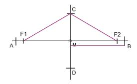
4) Diese Konstruktion kann viermal mit gleichen Zirkeleinstellungen wiederholt werden und ergibt vier Punkte der Ellipse.
