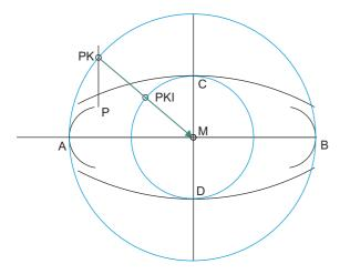
7) ..im Schnittpunkt mit der Vertikalen genau den Punkt P der Ellipse .
