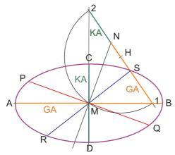
2) Diese definieren eine Ellipse und es sollen die beiden Hauptachsen AB und CD konstruiert werden. PQ wird um  $90^\circ$  gedreht und ergibt den Punkt N
