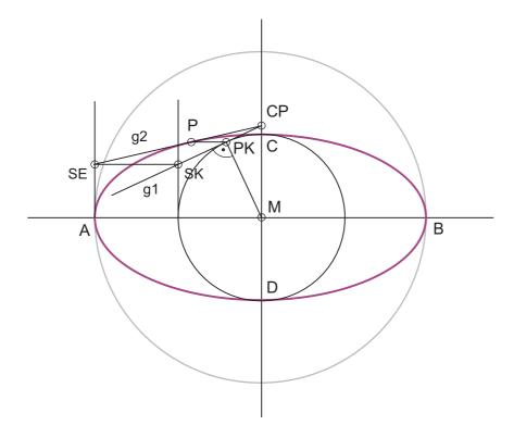
Die gleiche Konstruktion, wie auf Seite 2, ist, auch um 90° gedreht auf den kleinen Kreis der Ellipse bezogen, möglich.
