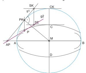
2) Im Überlappungsbereich der Krümmungskreise ist ein genauer Punkt P der Ellipse zu konstruieren.
