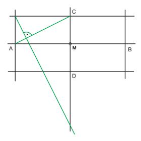
6) Von diesen Mittelpunkten RK und RG können nun die Krümmungskreise gezeichnet werden. Um die anderen beiden Krümmungskreise zeichnen zu können, werden die Mittelpunkte gespiegelt (rechts und oben)
