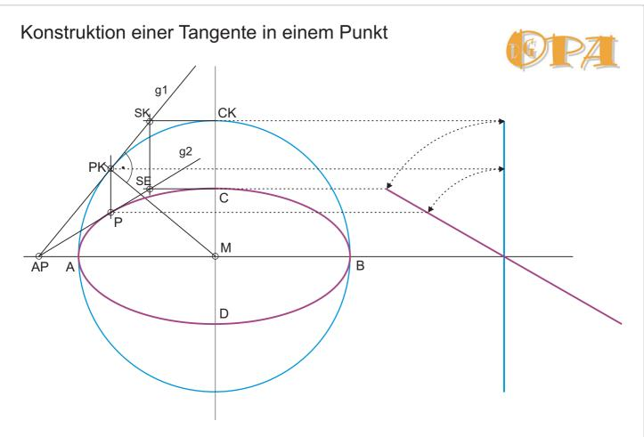
Im Punkt P der Ellipse soll eine Tangente konstruiert werden. Da eine Ellipse als schräge Ansicht eines Kreises gesehen werden kann, können alle Kreiskonstruktionen affin (zugeordnet) auf die Ellipse angewandt werden.
