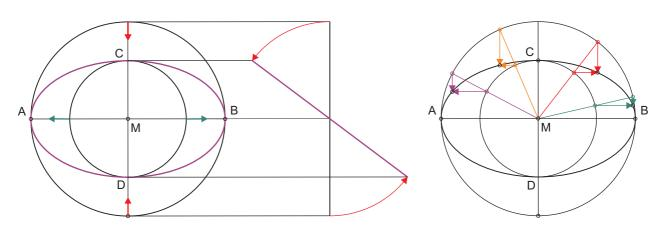
Werden nun beliebige Radien (violett, orange, rot, grün) in die Kreise eingezeichnet, so ergeben diese jeweils auf dem kleinen und dem großen Kreis affine (zugeordnete) Punkte. Werden von diesen aus die Verkürzung in vertikaler Richtung und die Dehnung in horizontaler Richtung ausgeführt, ergibt dies exakte Punkte auf der Ellipse. Siehe oberes, rechtes Bild. Dies ist eine Methode Ellipsen zu konstruieren, wenn die Scheitel (A, B, C, D) gegeben sind.
