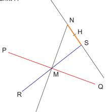
6) Durch 2 wird eine Verbindung mit M gezeichnet und auch von 1 aus durch M. Diese beiden Geraden sind senkrecht aufeinander (Thaleskreis) und geben die Richtung der gesuchten Durchmesser AB und CD an
