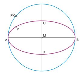
5) Der Tangentenpunkt PK wird auf die Ellipse rückgeführt und ergibt die Tangente durch den Punkt P.
