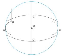
2) Im Überlappungsbereich der Krümmungskreise ist ein genauer Punkt P der Ellipse zu konstruieren.
