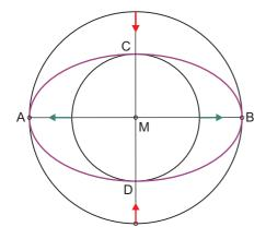
Die Ellipse hat eine große Achse AB und eine kleine Achse CD. Es lassen sich zwei Kreise bilden, einer mit dem großen Durchmesser AB und einer dem kleinen Durchmesser CD.
