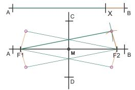
6) Jede Konstruktion eines Ellipsenpunktes kann vier mal mit denselben Zirkeleinstellungen ausgeführt werden und zusammen mit den Scheitelpunkten ist die Ellipse gut zu erkennen und kann gezeichnet werden.
