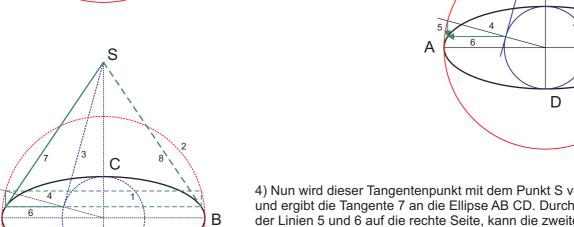
4) Nun wird dieser Tangentenpunkt mit dem Punkt S verbunden und ergibt die Tangente 7 an die Ellipse AB CD. Durch Spiegelung der Linien 5 und 6 auf die rechte Seite, kann die zweite Tangente 8 einer Kegeldarstellung konstruiert werden (gestichelt gezeichnet).
