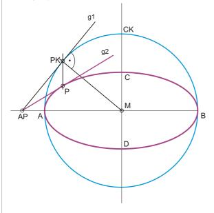
2) Ein Kreis mit dem Durchmesser der großen Achse, der "Großkreis" wird der Ellipse "umschrieben".
