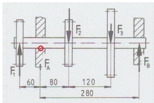
**\*) diese „+ 107N“ kommen zustande, da  $F_A$  an sich in der Gleichung zu subtrahieren wäre, da  $F_A$  aber negativ ist, also „-107N“ beträgt, müssen „+107N“ addiert werden.**
