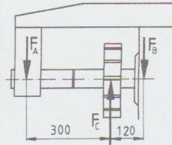
Begonnen wird mit der Drehmomentengleichung. Das Lager im Punkt B wird als Drehpunkt angenommen. Die Drehmomente werden in N/mm berechnet und verglichen
