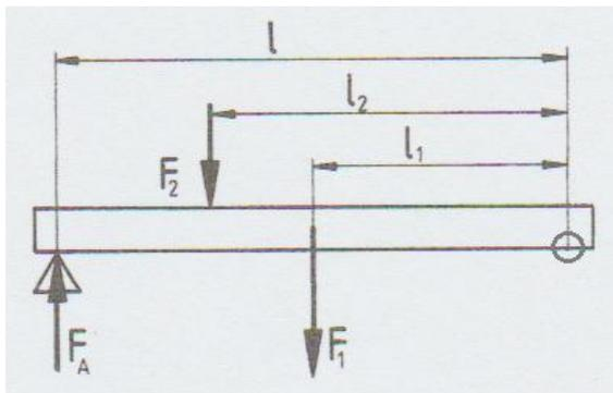
Die Drehmomente werden wie folgt berechnet:
