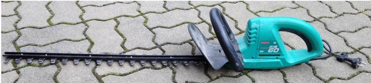
Die Heckenschere schneidet nur, wenn sowohl der der der Schalter im hinteren Griff, als auch der Schalter im Bogengriff gedrückt sind. Der Schalter im Bogengriff fiel oft aus. Auf der einen Seite des Bogengriffes (links oben) ist die Mechanik, die den elektrischen Schalter im Motorblock der Schere betätigt, auf der anderen Seite ist beim Bogen ein Teil abgebrochen, dadurch funktioniert diese Mechanik nicht korrekt. Die Lösung war eine neu gefertigte Hülse, die den Bogen exakt gelagert hat.
