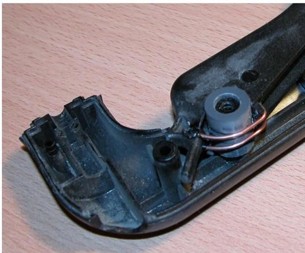
Mit CU-Drähten wurde diese Hülse fest an dem Bogen montiert, somit funktionierte auch die Mechanik wieder.
