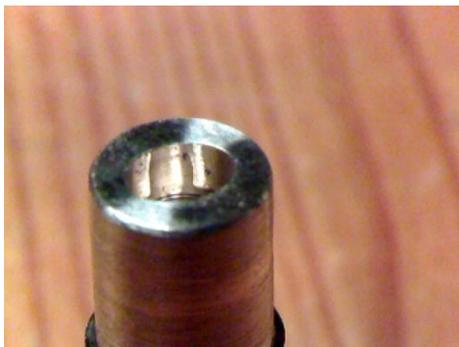
Danach konnte das Gerät zerlegt werden und eine mit Kalk verstopfte Leitung wurde gefunden. Der Kalk-pfropfen wurde angebohrt und dann wurde der Schlauch mit 25%tiger Essigsäure langsam gespült und damit der Kalk aufgelöst.
