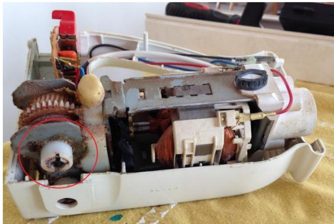
Die Ursache waren die abgenutzten Lager der Rührstabaufnahmen im Gerät.
