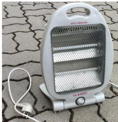
Möglicherweise wurde der Heizlüfter teilweise abgedeckt, wodurch ein Wärmestau im oberen Bereich entstand, der dann die Sicherung durchschmelzen ließ.
