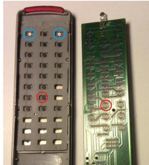
Abhilfe: Bestreichen der Tastenfläche mit Leitsilberlack (siehe blaue Kreise), der nach dem Trocknen wieder einen sicheren Kontakt auf den Leiterplattenmeander ermöglicht. Nach etwa einem Jahr wird auch diese Silbersicht brüchig und muss erneuert werden.
