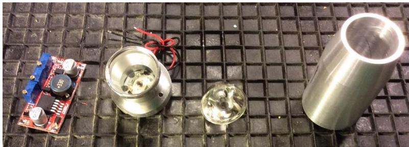
Links die Spannungs- und Strombegrenzung für die Power-LED, daneben die LED, daneben die Linse und rechts die Aluminiumhülse für Klinge und LED.
