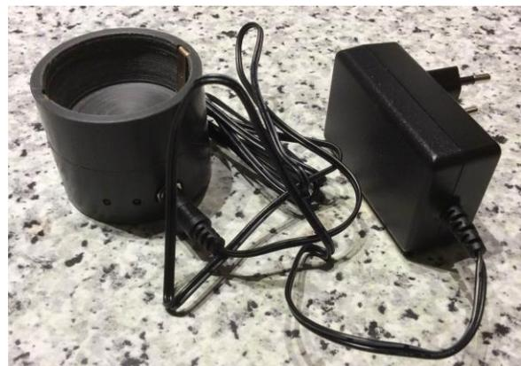
Mit einem fertigen Strom- und Spannungsregler der Fa. Neuhold-Elektronik (um etwa € 5.-, dieses Modul wird auch bei den LEDs der Klinge verwendet) und einem Universalnetzteil mit 12V, 1A werden über kleine Kontakte am Ende des Soundmoduls die Akkus im Schwert mit 8,2V und max. 0,5A (schonendere Ladung) geladen. Seitliche 3mm-LEDs zeigen Spannung und Ladestrom an.
