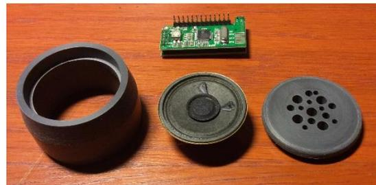
Alle Teile sind so gefertigt, dass sie fest zusammengesteckt werden können und nur mit großer Kraft wieder lösbar sind. Wird diese Genauigkeit nicht erreichen kann, kann sich mit seitlich angebrachten Wurmsschrauben abhelfen, die die jeweils inneren Zylinder klemmen.
