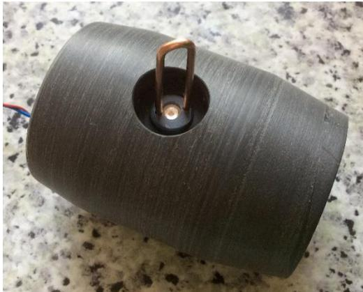
Die LED werden in die Kunststoffhülse (rechts) eingeklebt und dann mit einem kleinen Hilfsbügel justiert (links).
