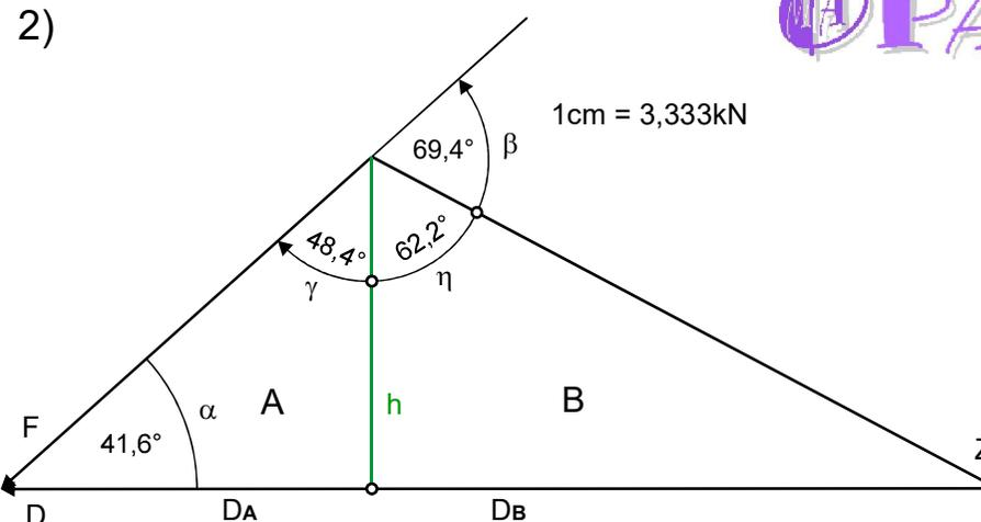
3) Im Dreieck B wird der obere Winkel  $\eta$  berechnet:  $\eta = 180^\circ - 69,4^\circ - 48,4^\circ = 62,2^\circ$
