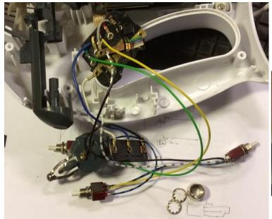
Die neuen Taster mussten nun eingebaut werden und dazu wurde der graue Teil gefräst, teilweise mir Kunststoff aufgefüllt und gebohrt.
