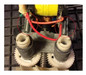
Als nächster Schritt sollte der Stufenschalter für die Geschwindigkeiten eingebaut werden und da wurde erkennbar, dass die Kunststoffträgerplatte "zerbröselt", also die kleinen schwarzen Teilchen leicht abbrachen, siehe Bild rechts. Daher konnte der Schalter nicht mehr verwendet werden. Eine neue Lösung musste gefunden werden. Es könnten statt dem Stufenschalter drei Taster die Wahlmöglichkeit, zwar etwas eingeschränkt, übernehmen.
