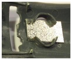
Hohlräume wurden mit Zweikomponentenkleber ausgegossen und die
