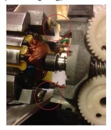
Nach dem Öffnen des Gerätes wurde festgestellt, dass der Lagerhalterteil beidseitig abgebrochen war. Siehe Bild links, rote Kreise.
