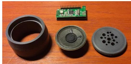
Alle Teile sind so gefertigt, dass sie fest zusammengesteckt werden können und nur mit großer Kraft wieder lösbar sind. Wird diese Genauigkeit nicht erreichen kann, kann sich mit seitlich angebrachten Wurmschrauben abhelfen, die die jeweils inneren Zylinder klemmen.
