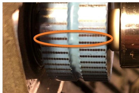
Bild rechts außen: Großaufnahme des Rotors, bei der die Verdrehung der beiden Magnetpole von Zahn auf Lücke zu sehen ist.
