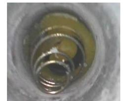
Dazu war es erforderlich den Teil, indem sich die Laserdiode befindet vom Batterieschacht zu trennen. Laut Herstellerfirma ist dieser Teil aufgeschraubt (wie auch der Schlüsselschalter), aber aus Sicherheitsgründen auch verklebt. Versuche diese verklebte Schraubverbindung durch großen Kraftaufwand bei dem die Oberfläche des Gerätes aber nicht verletzt werden durfte und zusätzlicher Erwärmung zu lösen, schlugen fehl.
