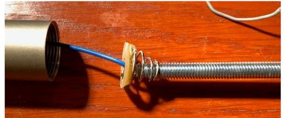
Die Kreisscheibe, auf der der Batteriekontakt aufgeklebt ist, hatte herstellungsseitig nicht die genaue Position und so wurde dies mit einem dafür angefertigtem Werkzeug (Bild unten) korrigiert.
