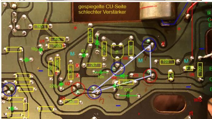
Diese Aufgabe war sehr zeitaufwändig, da die Bauteile von der Bauteilseite (siehe Bild unten) auf die Kupferseite (Leitungen) übertragen wurden. Dazu ist eine prinzipielle Kenntnis möglicher Verstärkerschaltungen im Kopf nötig, um sinnvolle Schaltpläne zu erstellen. Schwierig war dabei auch, dass die beiden Verstärker einen unterschiedlichen Aufbau (Layout) hatten (siehe beide linken Bilder).
