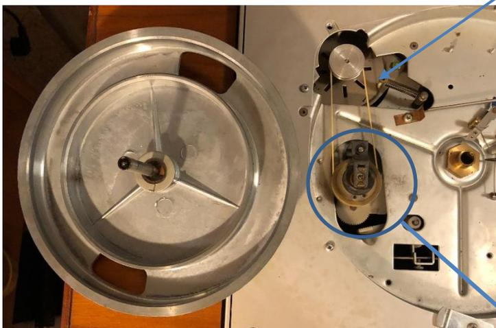
50Hz synchron läuft, treibt über eine Gummipese ein Reibrad, siehe Bild unten, welches am inneren Antriebsring des Plattentellers für 45U/min und am äußeren Antriebsring für 33U/min sorgt. Das Reibrad ist aus Gummi und war etwas abgerieben, hart und sehr glatt geworden. Deswegen hatte der Plattenspieler keine konstante Umdrehungszahl.
