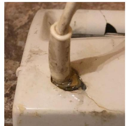
Nach dem Zusammenbau wurden alle offenen Löcher, das Gehäuse ist sehr porös und brüchig, geschlossen. Weitere Reparaturen werden ziemlich wahrscheinlich den Zusammenbruch (oder besser Auseinanderbruch) des Gehäuses im wahrsten Sinn der Worte zur Folge haben.
