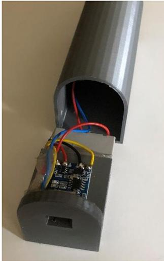
Links: Der Lade Teil mit Akku und Mini-USB-Buchse zum Laden an einer beliebigen 5V-Spannungsquelle (USB-Buchse im Computer oder USB-Netzteil für Handys).
