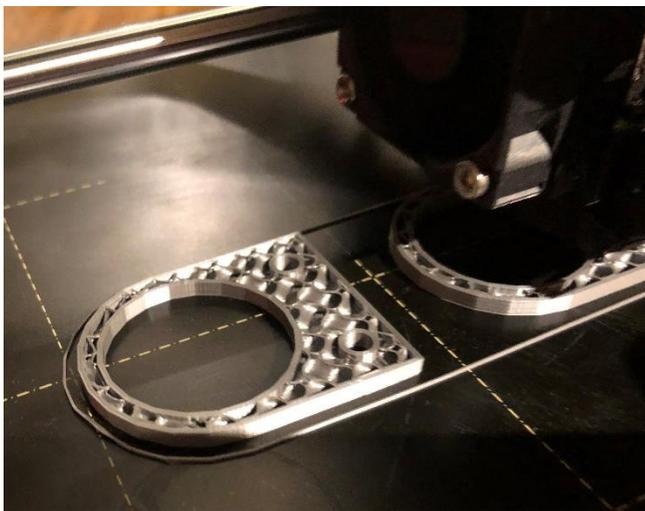
Links: 3D-Druck der beiden Motorhalter-Platten, während des Druckvorganges mit [PRUSA i3 MK3S](#) - Drucker.
