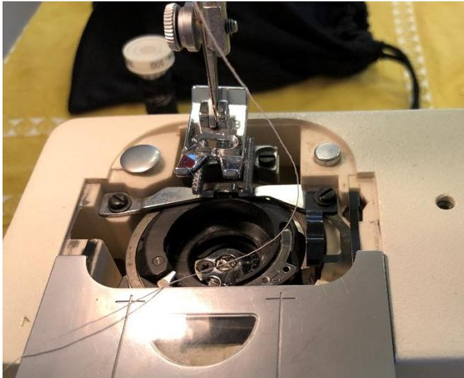
Leider war diese Mechanik bei der vorliegenden Maschine abgenutzt und funktionierte nicht mehr. Da keine andere Befüllung der Spule vorgesehen ist, musste eine neue Lösung gefunden werden, denn ein Aufwickeln des Fadens auf diese Spule von Hand aus, wäre zu zeitaufwändig.
