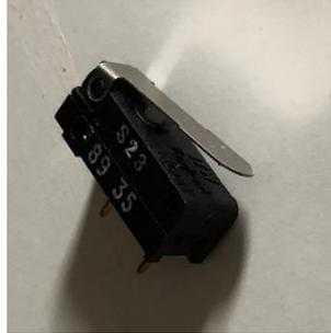
Links: Mikroschalter, der den Antriebsmotor einschaltet, wenn die eingelegte Spule angedrückt wird.
