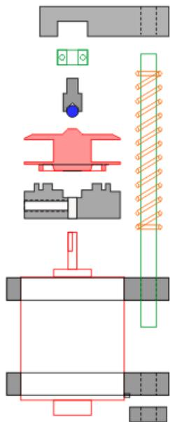
Links eine Zeichnung der Einzelteile, axial verschoben, rechts-Mitte: Spule eingelegt, rechts außen: Spule angedrückt, Motor läuft.
