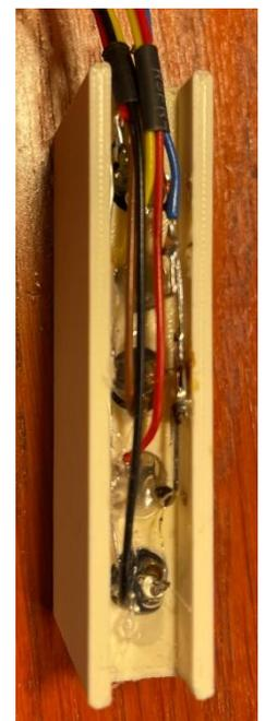
Um die Buchsen-Anschlussleisten des UNO zu schonen wurde eine kleine Zusatzplatine gefertigt, die dem UNO-Raster angepasst ist und ein leichtes Anschließen von GND, +5V, vom PWM-Anschluss und dem Ultraschallmodul ermöglicht.
