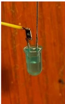
Alle Widerstände der Schaltung sind SMD-Bauteile, daher sehr klein und mit Pinzette zu löten, siehe linkes Bild.
