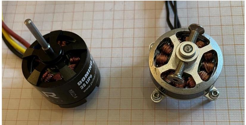
Brushless-Motoren bestehen aus einem Stator, der innen aus einzelnen sternförmig angeordneten, elektrisch erregten Polen besteht (z.B. 12 Pole) und einem rotierenden Rotor außen, der mit einzelnen Dauermagneten (z.B. 13 Magnete) bestückt ist. Da der Radius der Kraftwirkung außen größer ist, wird ein deutlich höheres Drehmoment auch bei kleinen Abmessungen erzielt.
