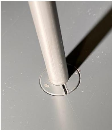
Nun kann durch Verdrehen des Ringes der Abstand der Leitrohre exakt eingestellt werden.
