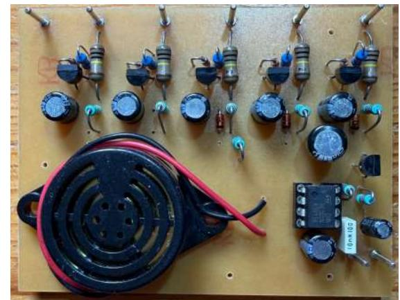
Werden mehr als fünf Phasen überprüft, sind Erweiterungsplatten nötig, auf denen lediglich die jeweiligen Phasensensoren vorhanden sind. Diese Platten werden über den Eingangssensoren der Grundplatte etagenweise gestapelt. Sie sind mit fünf Kontakten mit der Grundplatte verbunden. Auf den nächsten Seiten sind die Layouts der verschiedenen Schaltungen mit Bestückungsplan aufgeführt.
